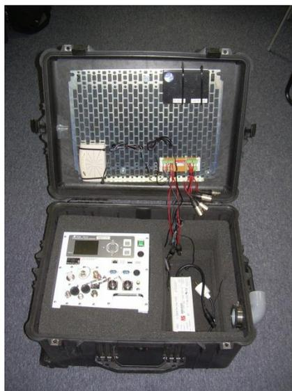
La valise peut être alimentée en 220V ou en 12V ce qui permet d'alimenter le système avec des longueurs de câbles importantes sans aucun risque pour les usagers. L'utilisation de câbles plats spéciaux permet de passer sous les portes et fermer ces dernières.
