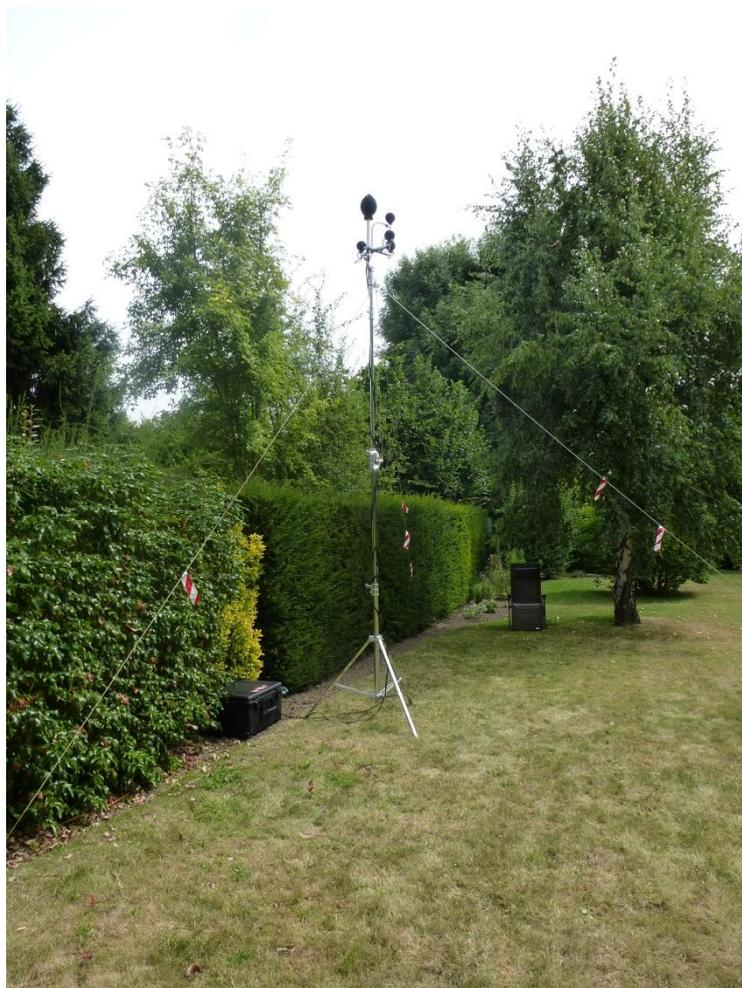
*Figure 2.1 : station experte RION NA37 déployée dans le cadre de la campagne de mesure.*
